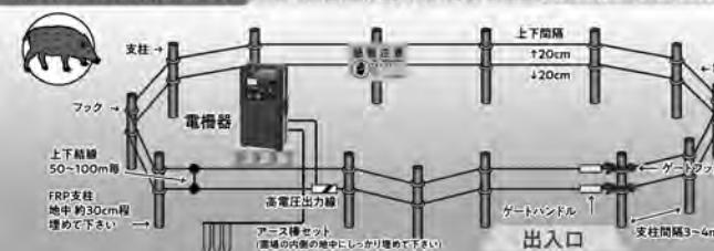
設置例 シカ対策5段張り > ぐるり囲むないように下段の柵線の位置と、飛び越えない高さの位置に柵線を通って下さい。
