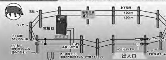
設置例 シカ対策5段張り > ぐるり囲むないように下段の柵線の位置と、飛び越えない高さの位置に柵線を張って下さい。
